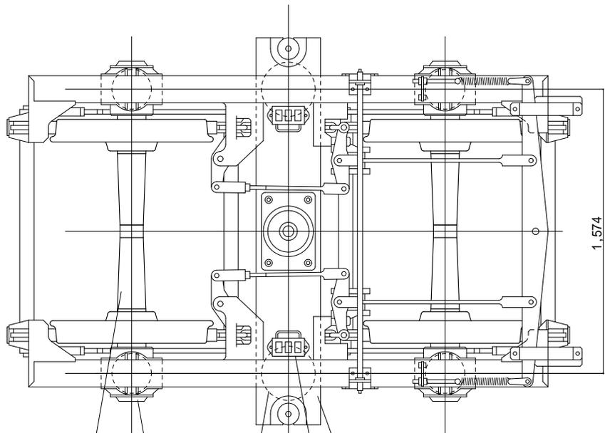
輪軸 軸箱 マクラバネ 上揺レマクラ
